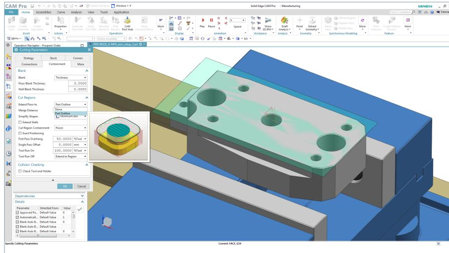
añadir códigos de espera y sincronización. El responsable de la sincronización, una figura muy práctica dada la complejidad de las máquinas de fresado y torneado, se vincula directamente con el posprocesador interno y se ejecuta desde el resultado publicado para obtener una mayor precisión.
